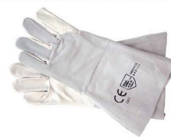
Rękawice ochronne RSPLLUX wykonane ze skóry bydlecej, dwoina wzmocniana skórą licową. Długość rękawicy 35 cm.
