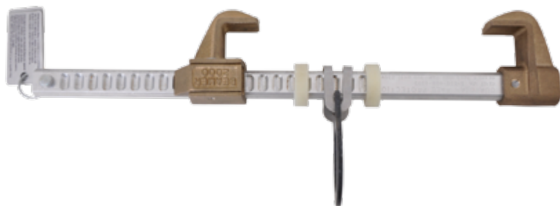
AKSA08 PUNKT KOTWIENIA DO BELEK STALOWYCH EN795 KLASA B Wykonany z aluminium i mosiądzu, punkt zalecany do kotwienia do stalowych belek. Waga: 1550 gr.
